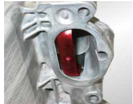
Перекидная заслонка (выделена красным цветом) для режима послыного заряда
