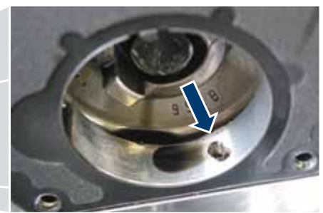
Пример: у автомобиля Opel Vectra подвод смазочного масла происходит через отверстия во фланце
