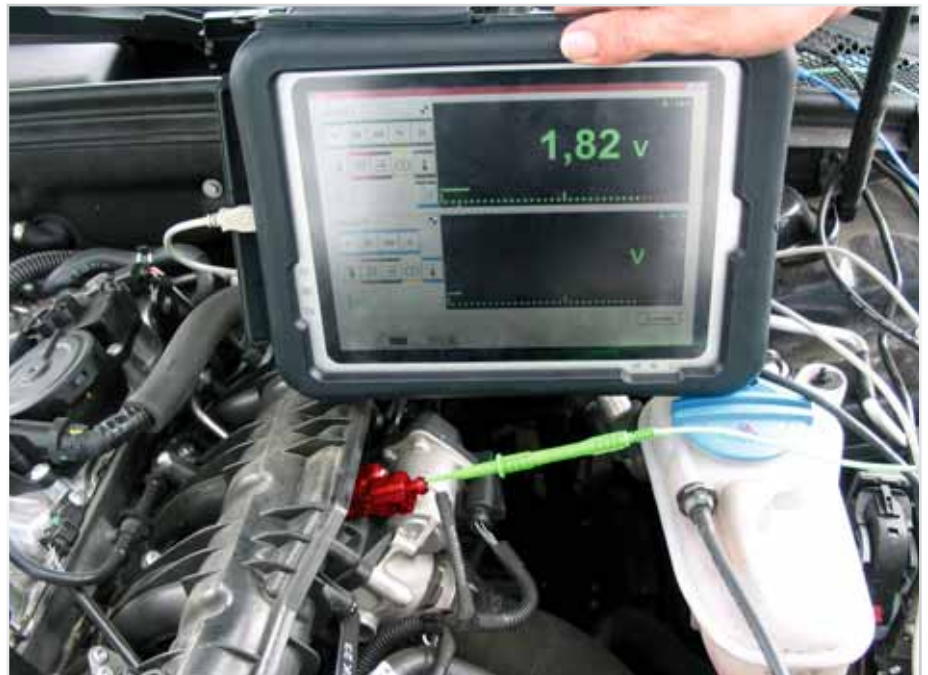
Измерение выходного напряжения на сенсоре давления во впускной трубе (выделено другим цветом) в Audi A4 TFSI
