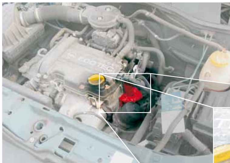
Электрический клапан системы EGR в Opel Corsa (выделен)
