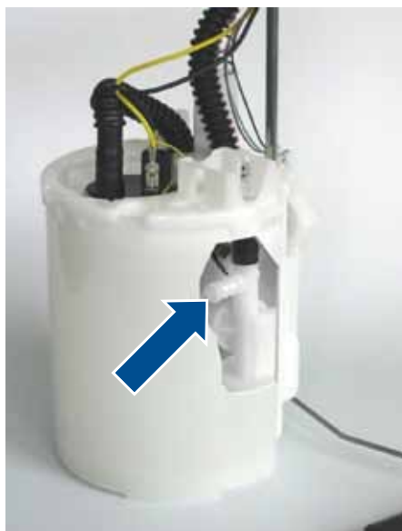
Рис. 1: взгляд на модуль подачи топлива (вид спереди) с глухим присоединением
