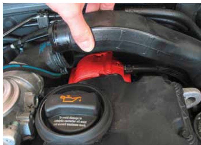
Топливный/вакуумный насос в автомобиле VW Passat (выделен красным цветом)
