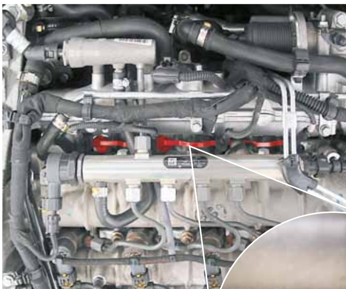
Система тяг на впускном коллекторе в Opel Vectra (сверху выделена красным цветом и вид детали)
