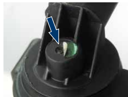
Рис. 2: Это отверстие (указано стрелкой) может привести к проникновению воды и выходу из строя.
