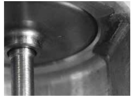
Рис. 3: Негерметичное седло клапана (указано стрелкой) влечет за собой проблемы.
