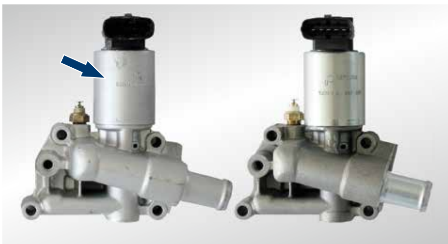
Рис. 1: Лакированный клапан системы EGR (указан стрелкой) похож на новый — но он не новый.
