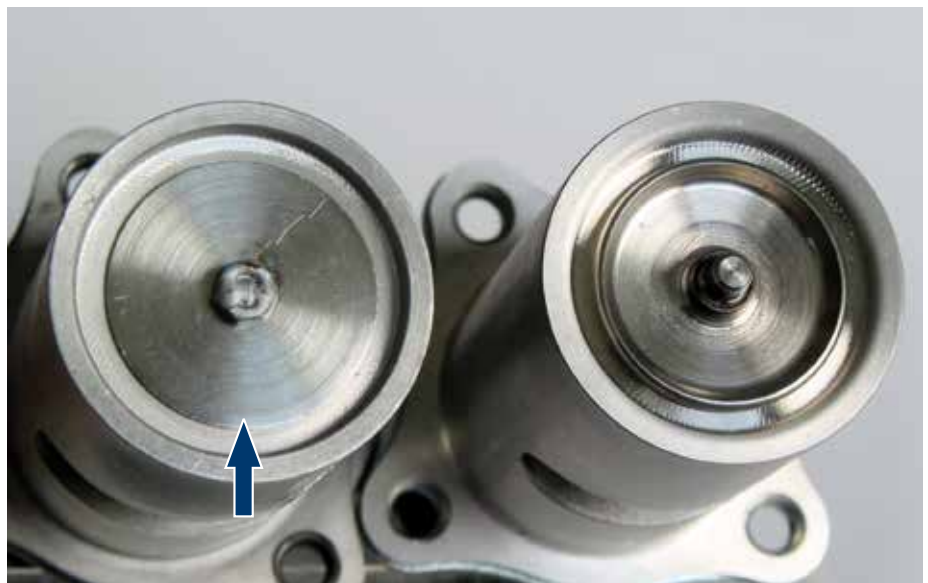
Рис. 4: Приваренный диск из листового металла (указан стрелкой) не способен заменить седло клапана.
